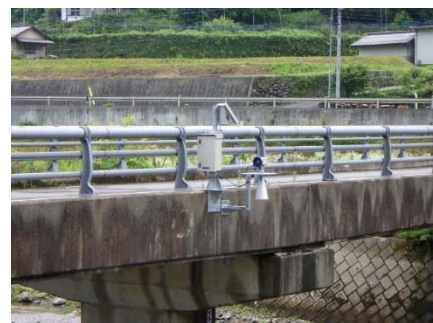
危機管理型水位計（洪水時の水位観測に特化した低コスト水位計）
